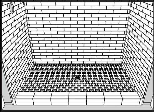
11. Ajuste la altura del desagüe según sea necesario para acomodar la cubierta del piso. Fije su azulejo usando mortero para azulejo / Thin-Set modificado blanco y una cuchara con muescas tal y como se especifica por el fabricante del mortero de azulejo / Thin-Set con base en el tamaño de su azulejo. Tile Redi recomienda los productos mortero para azulejo / Thin-Set modificado que se encuentran en la siguiente tabla.
