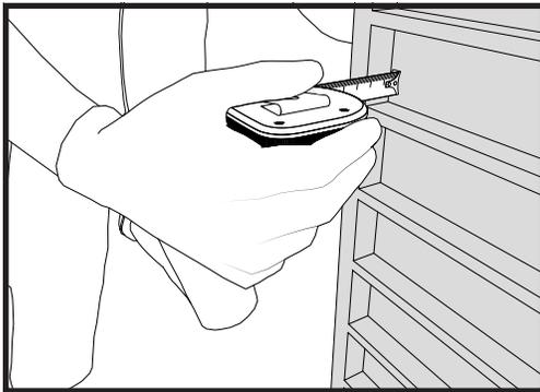
4. Dé la vuelta a la base de la regadera y observe que hay líneas debajo del piso de la base de la regadera. Para calcular la cantidad necesaria de mortero, usted necesitará saber la profundidad del punto más profundo entre las líneas. Una vez que tenga dicho valor, calcule el espesor (profundidad) de la base de su mortero (mortero tipo N o S) usando la siguiente fórmula:
