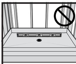
**NO USE LA PARTE INTERNA DE LA BASE COMO UN INDICADOR YA QUE LA BASE ESTÁ PREVIAMENTE SUBDIVIDIDA. NO PISE DENTRO DE LA BASE DE LA REGADERA UNA VEZ QUE ÉSTA HAYA SIDO COLOCADA Y NIVELADA Y HASTA QUE EL MORTERO HAYA SECADO COMPLETAMENTE.**
