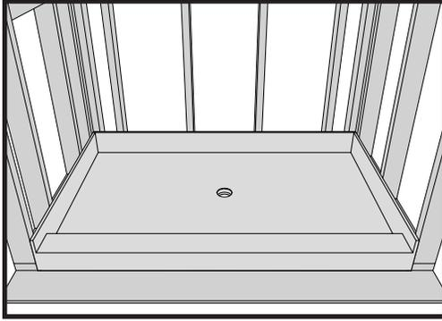
**Instalación de Redi Free®:** Para una instalación adecuada de la base sin barrera arquitectónica, el contra piso se debe empotrar (de acuerdo con los códigos locales) a una profundidad del borde frontal de la base. Impermeabilice la unión entre la base de la regadera y el contra piso con una cinta impermeable y una membrana aplicada en líquido.
