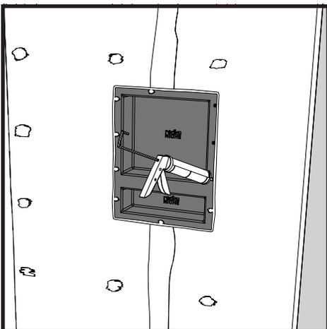
6. Aplique cuidadosamente silicona 100% impermeabilizante para cubrir cada cabeza de tornillo y rellenar el hueco entre el borde del nicho y la placa de regadera adyacente.
