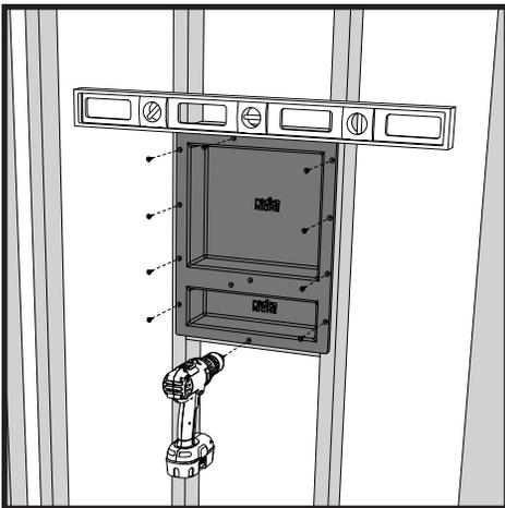
4. Nivele y fije mecánicamente el Redi Niche utilizando un tornillo de carpintería en cada orificio preperforado.
