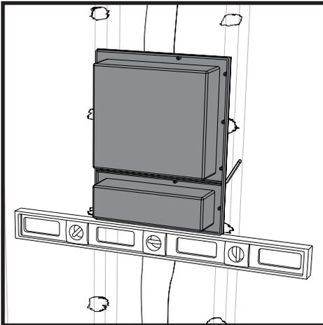
a. Coloque el nicho entre los dos montantes marcados con las paredes del reborde a ras de la pared y marque el contorno del nicho en la pared. Asegúrese de que las líneas superior e inferior estén niveladas.
