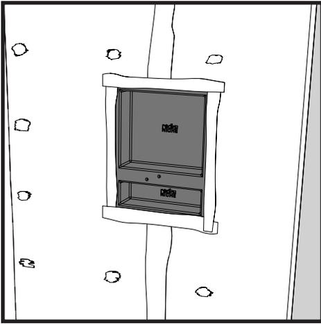
7. A continuación, aplique una membrana impermeabilizante de aplicación líquida a los cuatro bordes del nicho y cubra al menos 1 pulgada de la placa de soporte de azulejos adyacente.
