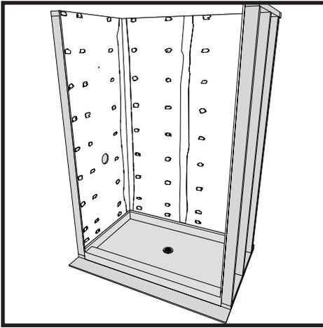
1. Si va a enmarcar el Redi Niche en una pared acabada existente (si es una construcción nueva, vaya al paso 2), primero ubique y marque el centro de los montantes de enmarcado adyacentes utilizando un localizador de montantes o golpeando la pared. Marque una línea nivelada entre los dos montantes de la pared.
