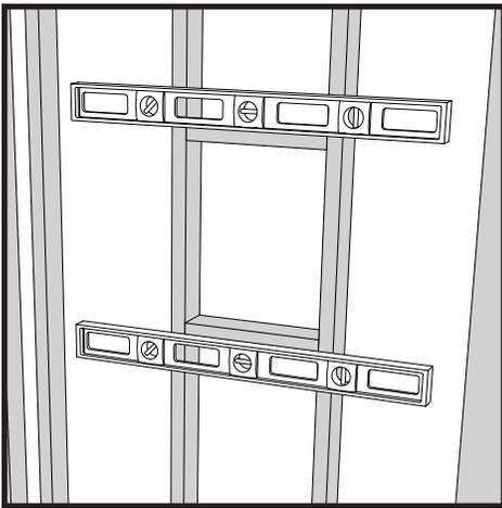
3. Mida y corte los marcos de soporte horizontal superior e inferior a una longitud que permita que cada uno de ellos pase entre los montantes verticales y se fije a ellos. Nivele y fije mecánicamente los soportes horizontales superior e inferior a ambos montantes verticales adyacentes, de modo que la dimensión vertical entre los marcos de soporte horizontales coincida con la dimensión vertical de los orificios de fijación pretaladrados en el borde del Redi Niche.
