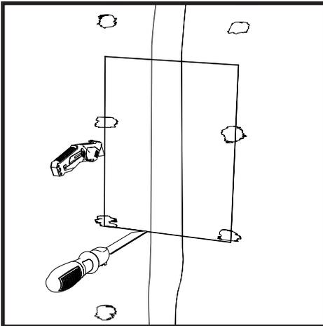
b. Recorte el tablero de la pared a lo largo de las líneas trazadas entre los dos montantes utilizando una sierra para tablero de respaldo y un exacto.
